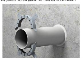
2a Die Manschette verfügt über eine doppelte Schlitzung. Es ist die zum Außendurchmesser passende Schlitzung zu verwenden.
